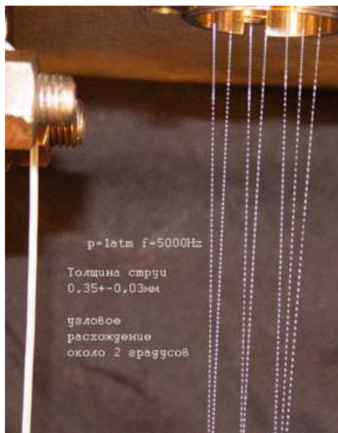
Рис. 8. Типичная картина отклонений струек, возникших из-за неточностей изготовления фильеры.
